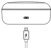
Durante o processo de carga o estojo indica a carga atual conforme a quantidade de LEDs acesos, 25%, 50%, 75%, 100%.
