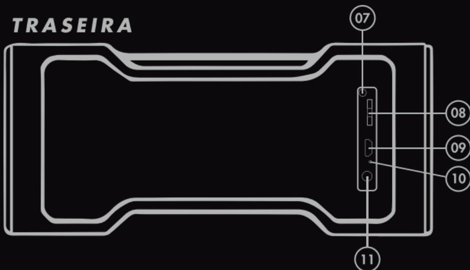
**07 - Aba de proteção** das conexões de entrada. Mantenha-a fechada para uso em ambientes úmidos ou com risco de contato com água;
