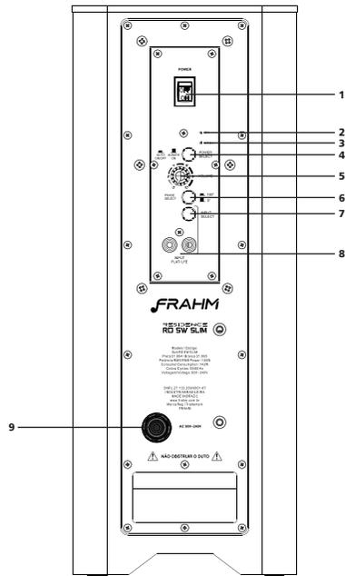
**1. CHAVE POWER:** A Chave Power liga e desliga o subwoofer. Quando esta chave está na posição ON, o Led indicador acenderá. Esta chave pode permanecer normalmente na posição ON, devendo ser desligada quando o subwoofer não for usado por um período prolongado em conjunto com o POWER SELECT (4);
