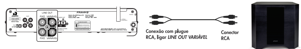
Exemplo de ligação ideal de um Slim em um subwoofer
