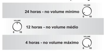
OBS.: A bateria reduz sua capacidade de armazenar carga com o passar do tempo, reduzindo gradativamente a autonomia da caixa. Os testes de autonomia da caixa foram realizados com bateria nova e 100% carregada.
