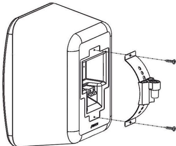
**Passo 6:** Encaixe o suporte da caixa no suporte da parede.
