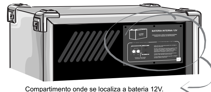
Compartimento onde se localiza a bateria 12V.
