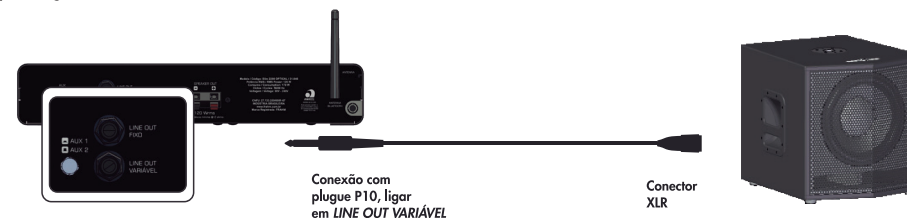
Exemplo de ligação ideal de um Slim em um subwoofer.
