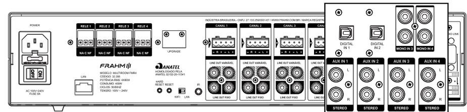
É importante ressaltar que, apesar de haver 8 entradas disponíveis, somente 4 delas podem ser utilizadas simultaneamente. As opções de escolha são: Aux IN1 ou Digital IN1, Aux IN2 ou Digital IN2, Aux IN3 ou Mono 3 e Aux IN4 ou Mono 4. As quatro opções mencionadas são predefinidas, e a partir delas é possível direcionar o sinal para qualquer canal de saída do sistema multiroom. A figura abaixo ilustra o funcionamento do controle do produto.
