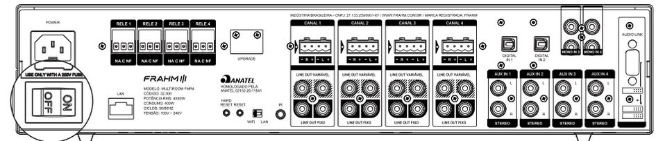
A chave atrás do produto deve estar sempre ligada, o amplificador deve ser colocado em stand-by através do controle remoto, ou via automação. Isso permite que ele esteja em modo de espera para receber qualquer comando de ativação posterior.
