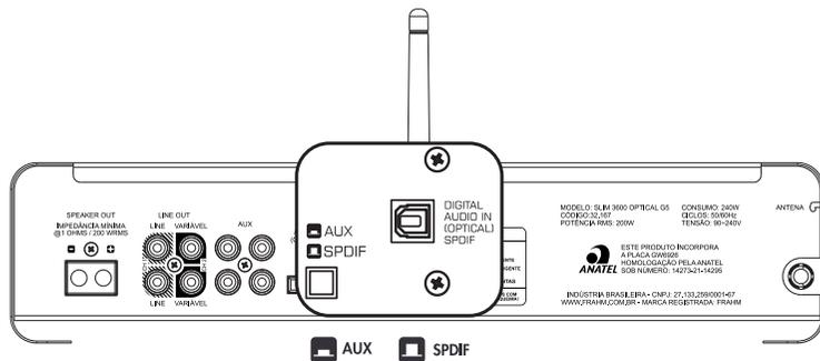
**IMPORTANTE** - Ao utilizar a entrada AUXILIAR, colocar no modo LINE e optar pela entrada através da chave traseira.
