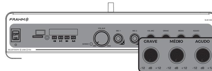
O 3600 Optical possui ajustes de equalização para graves, médios e agudos (três vias), que atuam no canal de microfone e no canal auxiliar.
