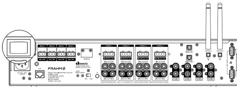
A chave atrás do produto deve estar sempre ligada, o amplificador deve ser colocado em stand-by através do controle remoto, ou via automação. Isso permite que ele esteja em modo de espera para receber qualquer comando de ativação posterior.
