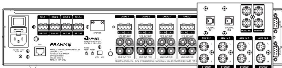
É importante ressaltar que, apesar de haver 8 entradas disponíveis, somente 4 delas podem ser utilizadas simultaneamente. As opções de escolha são: Aux IN1 ou Digital IN1, Aux IN2 ou Digital IN2, Aux IN3 ou Mono 3 e Aux IN4 ou Mono 4. As quatro opções mencionadas são predefinidas, e a partir delas é possível direcionar o sinal para qualquer canal de saída do sistema multirroom. A figura abaixo ilustra o funcionamento do controle do produto.
