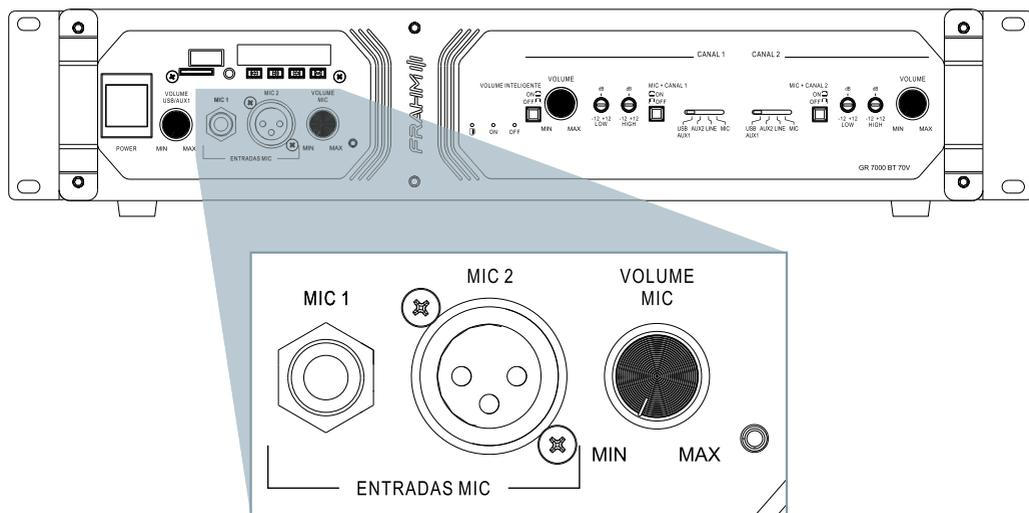
CONEXÃO COM PLUG P10
