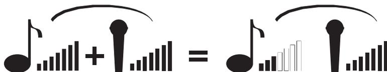
O GR 7000 BT 70V possui o recurso de Volume Inteligente, que pode ser habilitado ou desabilitado, de acordo com a aplicação do aparelho (ver no final da página como fazer esta configuração) Através de um circuito interno, o GR 7000 BT 70V reconhece o som da voz, através do canal de microfone e automaticamente diminui o som da trilha sonora de audio que está sendo reproduzida através das AUX1/USB ou AUX2, deixando em destaque a locução do usuário.
