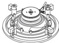
**Passo 3** - Conecte a fiação nos terminais, observando a polaridade e encaixe a arandela no recorte do teto.
