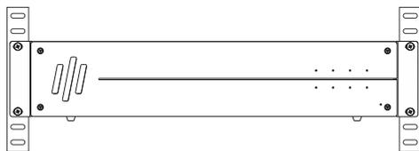
Posicione o produto na posição desejada no rack, utilize os parafusos que acompanham o produto para fixar o amplificador através dos furos no rack suporte;
