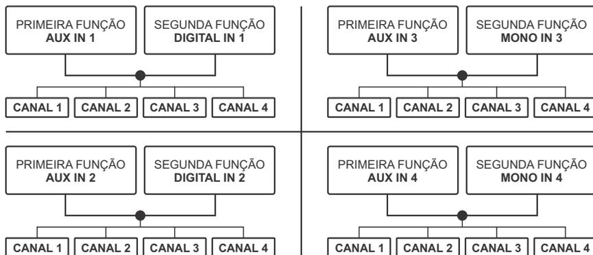
Além disso, o produto está equipado com um dispositivo de limitação de sinal nas entradas de áudio, garantindo que o sinal seja limitado a valores de até 300mV. Isso assegura a qualidade do sinal de entrada e evita distorções indesejadas. **ATENÇÃO!** É importante destacar que o sinal de entrada de áudio deve ser inferior a 1 V RMS.
