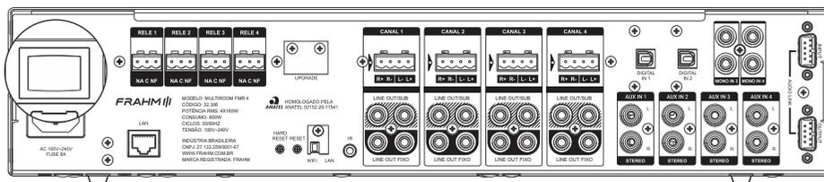
A chave atrás do produto deve estar sempre ligada, o amplificador deve ser colocado em stand-by através do controle remoto, ou via automação. Isso permite que ele esteja em modo de espera para receber qualquer comando de ativação posterior.
