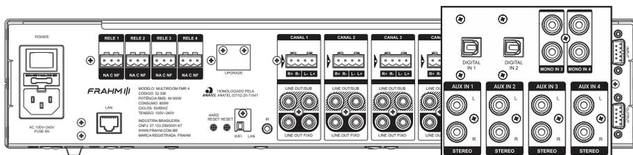
É importante ressaltar que, apesar de haver 8 entradas disponíveis, somente 4 delas podem ser utilizadas simultaneamente. As opções de escolha são: Aux IN1 ou Digital IN1, Aux IN2 ou Digital IN2, Aux IN3 ou Mono 3 e Aux IN4 ou Mono 4. As quatro opções mencionadas são predefinidas, e a partir delas é possível direcionar o sinal para qualquer canal de saída do sistema multiroom. A figura abaixo ilustra o funcionamento do controle do produto.
