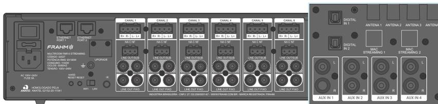
É importante ressaltar que, apesar de haver 8 entradas disponíveis, somente 4 delas podem ser utilizadas simultaneamente. As opções de escolha são: Aux IN1 ou Digital IN1, Aux IN2 ou Digital IN2, Aux IN3 ou Streaming 1 e Aux IN4 ou Streaming 2. As quatro opções mencionadas são predefinidas, e a partir delas é possível direcionar o sinal para qualquer canal de saída do sistema multiroom. A figura abaixo ilustra o funcionamento do controle do produto.
