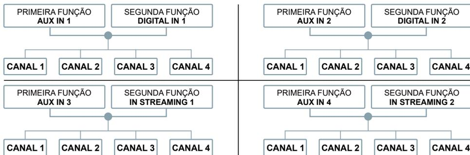
Além disso, o produto está equipado com um dispositivo de limitação de sinal nas entradas de áudio, garantindo que o sinal seja limitado a valores de até 300mV. Isso assegura a qualidade do sinal de entrada e evita distorções indesejadas. **ATENÇÃO!** É importante destacar que o sinal de entrada de áudio deve ser inferior a 1 V RMS.
