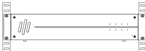
Posicione o produto na posição desejada no rack, utilize os parafusos que acompanham o produto para fixar o amplificador através dos furos no rack suporte;
