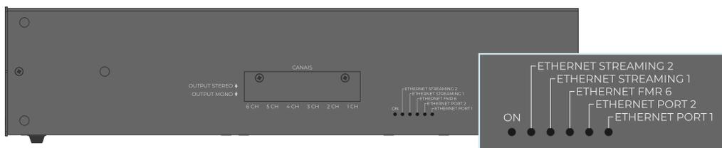
Cada LED representa uma interface de rede específica: Ao ligar o equipamento, os LEDs de Ethernet Streaming 1 e Ethernet FMR 6 devem acender, indicando que estão ativos. Os LEDs de Ethernet Port 1 e Ethernet Port 2 só acendem quando há um cabo conectado a eles.
